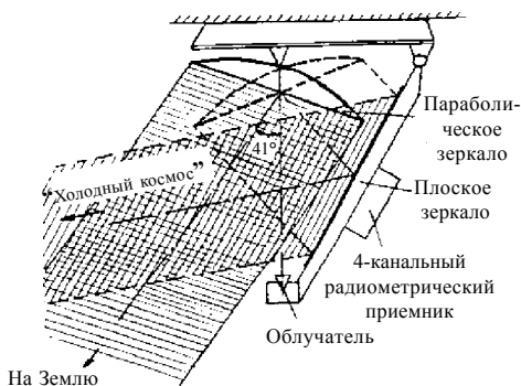
Рис. 7.17. Компоновка АФУ
