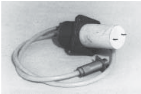
Рис. 1.13. Внешний вид ЗДП с изолятором из материала ВИО-18
